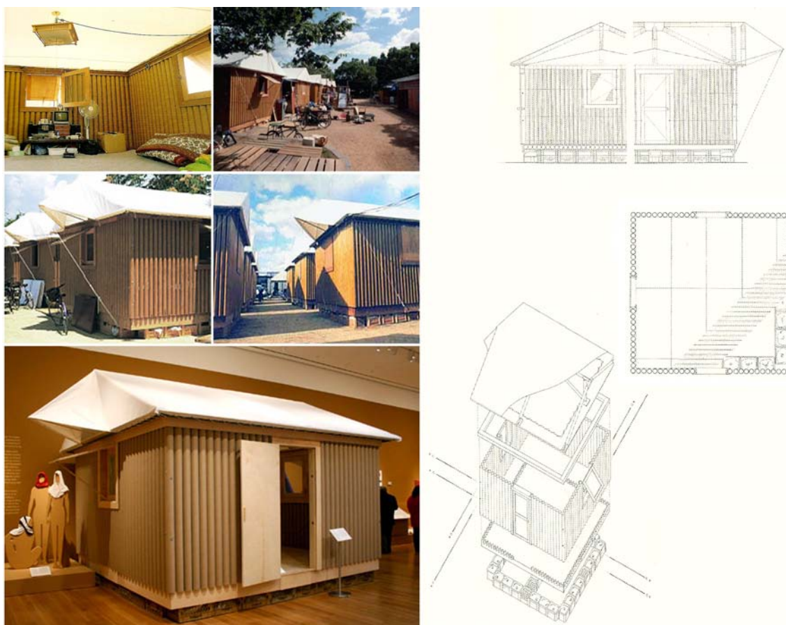
Fig.64- Diversas vistas da Paper Log House. Alçado, planta e perspectiva axonométrica. E uma reprodução da mesma no MoMA
