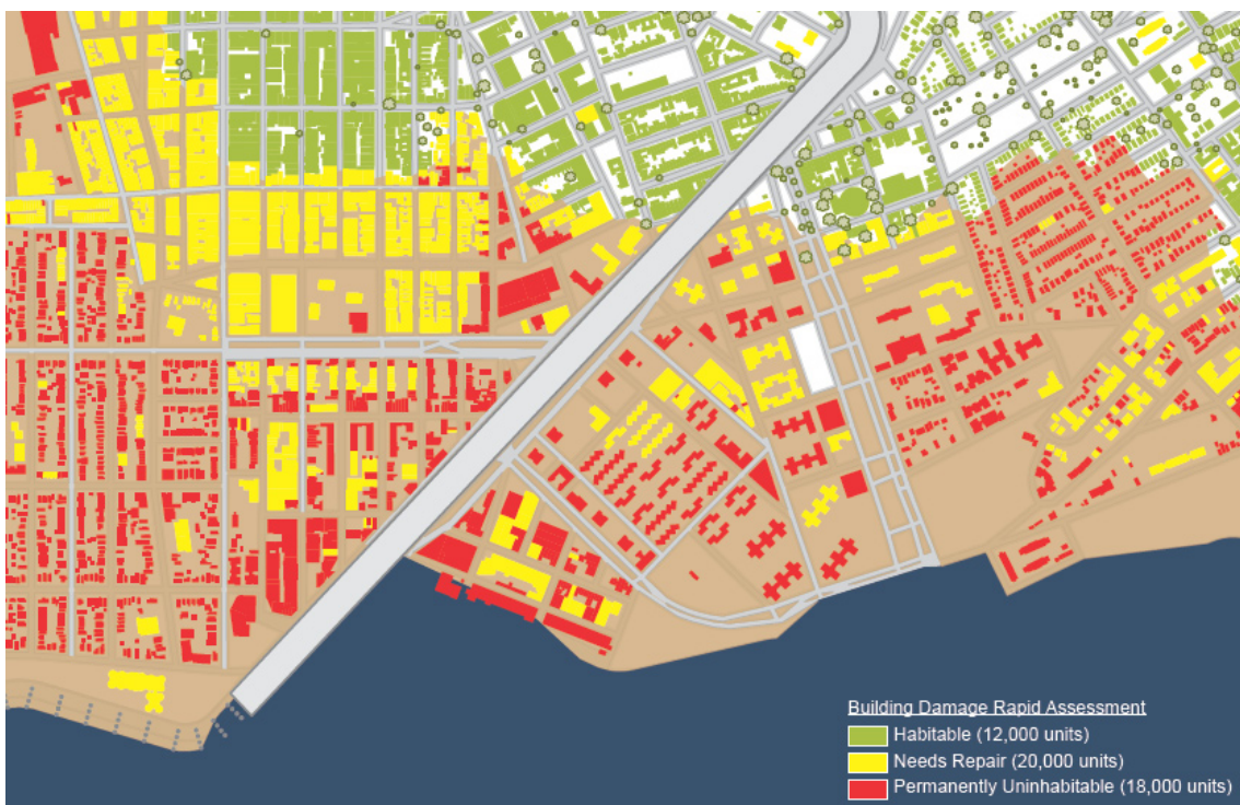
Fig.88- Avaliação dos edifícios após a catástrofe
