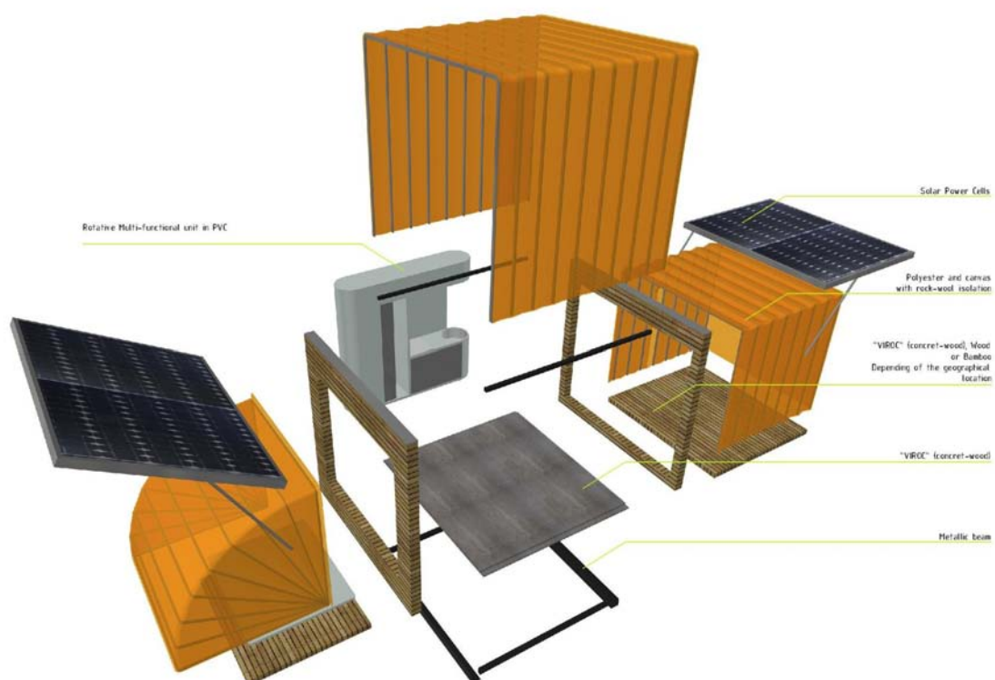
Fig.80- Perspectiva axonométrica do módulo
