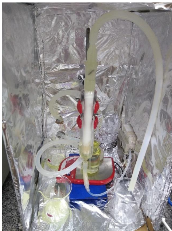
Figura 6. 5 - Sistema reacional utilizando reator de leito fixo na síntese de lipídio estruturado do tipo MLM em modo contínuo.
