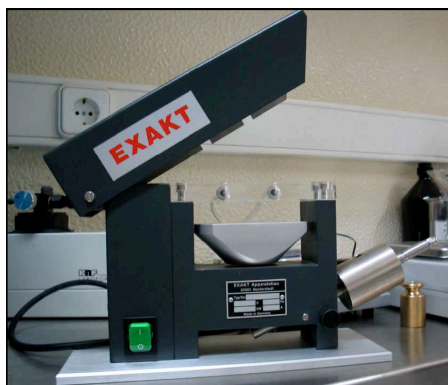
Fig.20- Prensa fotopolimerizadora para montagem da segunda lâmina pela técnica de sanduíche.
