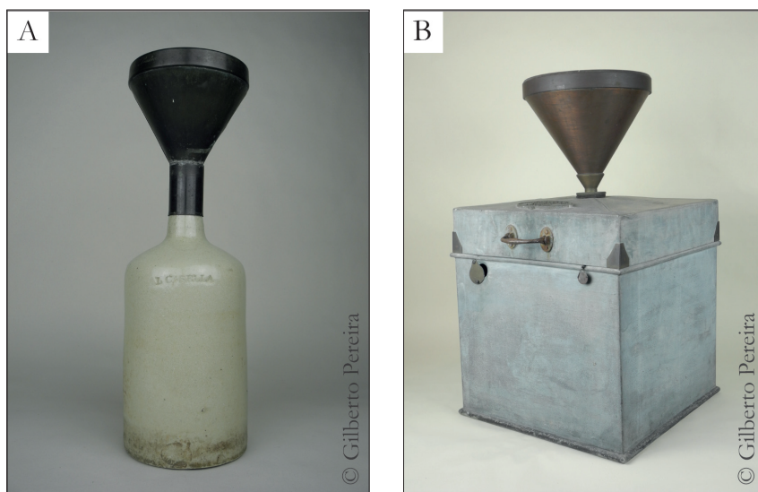
Fig. 2 - Instrumentos utilizados para medição da precipitação (A - Udómetro; B - Udógrafo) (Fonte: Projeto HISTIGUC – 150 anos de história do IGUC).
