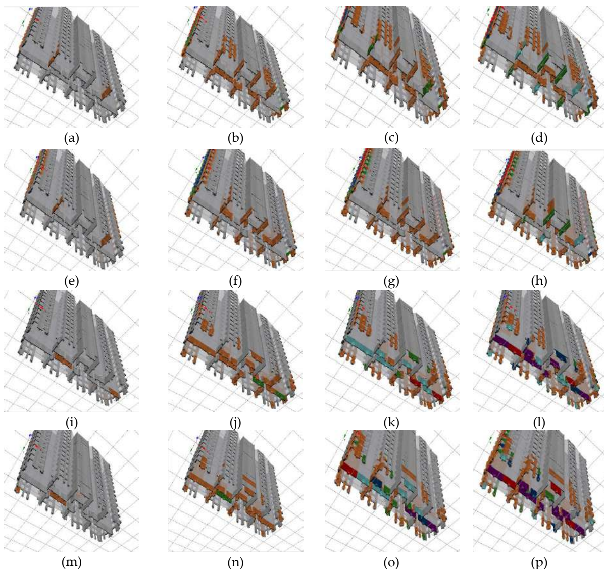
Figura 22. Mecanismo de progresión de daño para distintos niveles de derivas global. (a) 0,002 en Y+, (b) 0,005 en Y+, (c) 0,006 en Y+, (d) 0,0068 en Y+, (e) 0,002 en Y-, (f) 0,005 en Y-, (g) 0,006 en Y-, (h) 0,0068 en Y-, (i) 0,002 en X+, (j) 0,005 en X+, (k) 0,0066 en X+, (l) 0,0092 en X+, (m) 0,002 en X-, (n) 0,005 en X-, (o) 0,0066 en X-, (p) 0,0092 en X-.
