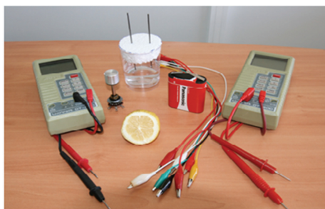
Figura 4: Circuito elétrico para o estudo das características do voltâmetro (recetor)
