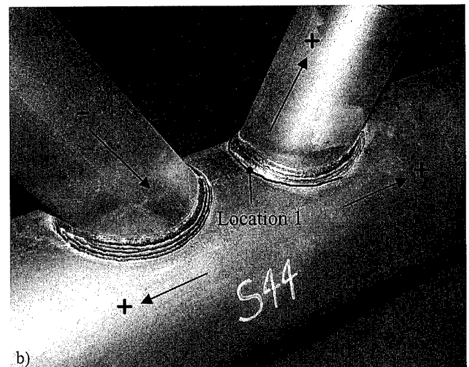
Bild 4. Ort der Rißinitiiierung in den Versuchsknoten Fig. 4. Location of cracks in test joints
