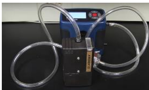
Figura 2 – Bomba de amostragem conectada ao calibrador de fluxo, através de um tubo flexível contendo o filtro para amostrar
