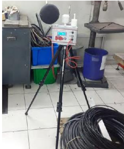
Figura 13 - Equipamento de monitorização de ambiente térmico
