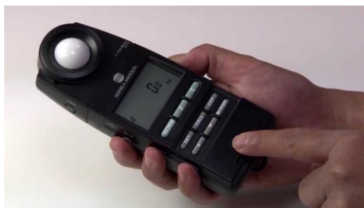
Figura 10 - Luxímetro de medição direta
