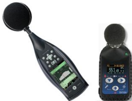
Figura 11 – Sonómetro modular de precisão e dosímetro
