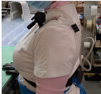
Figura 7 - Amostragem pessoal de Sílica Livre Cristalina
