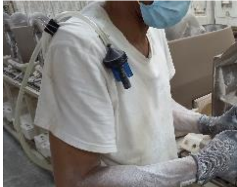
Figura 3 - Amostragem pessoal – posicionamento do amostrador
