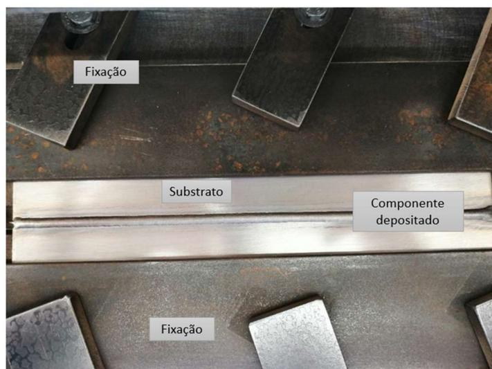
**Figura 3.1.** Posicionamento do substrato.
