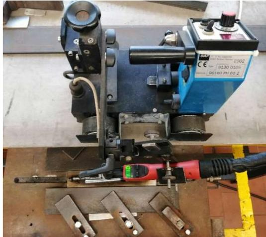
**Figura 3.2.** Carrinho de soldadura, SAF, e tocha de soldadura com alimentação automática.
