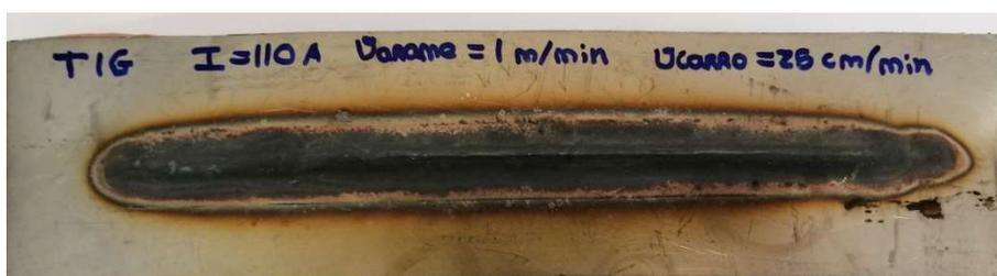
Figura 6.2. Parte inferior do componente multicamada P1 (sentido da deposição, da esquerda para a direita).
