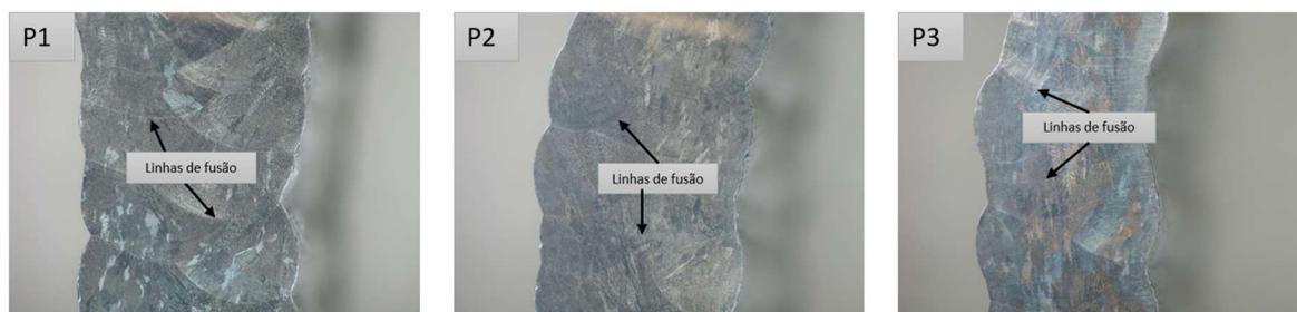
**Figura 4.22.** Zona do meio dos componentes multicamada, com linhas de fusão evidenciadas, componentes P1, P2 e P3. Ampliação 1,25x.
