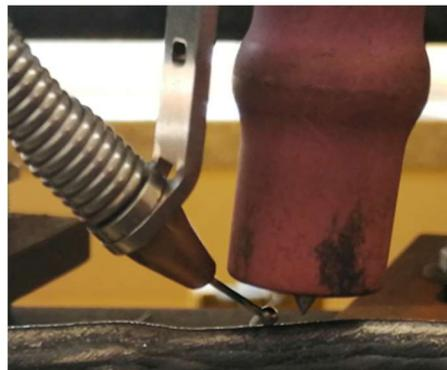
**Figura 3.3.** Posicionamento do eléctrodo de tungsténio e do arame de adição em relação ao componente.
