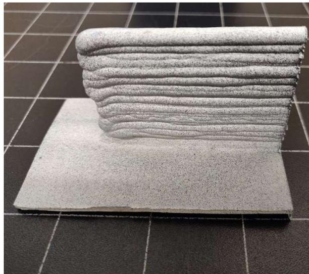
**Figura 3.6.** Superfície do componente multicamadas P1, com padrão aleatório de pontos negros.
