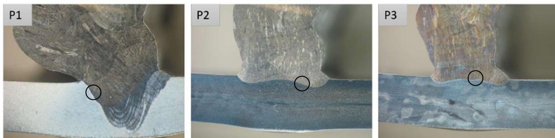
**Figura 4.20.** Zona da base dos componentes multicamada, P1, P2 e P3, evidenciando as zonas das quais foram retidas as micrografias. Ampliação 1,25x.
