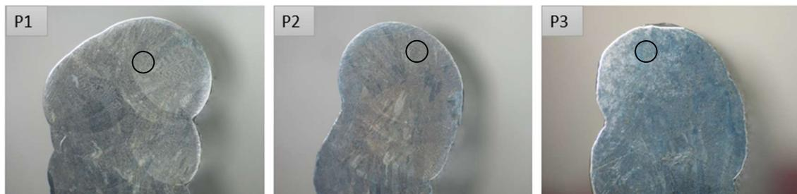
**Figura 4.24.** Zona do topo dos componentes multicamada, P1, P2 e P3, evidenciando as zonas das quais foram retidas as micrografias. Ampliação 1,25x.
