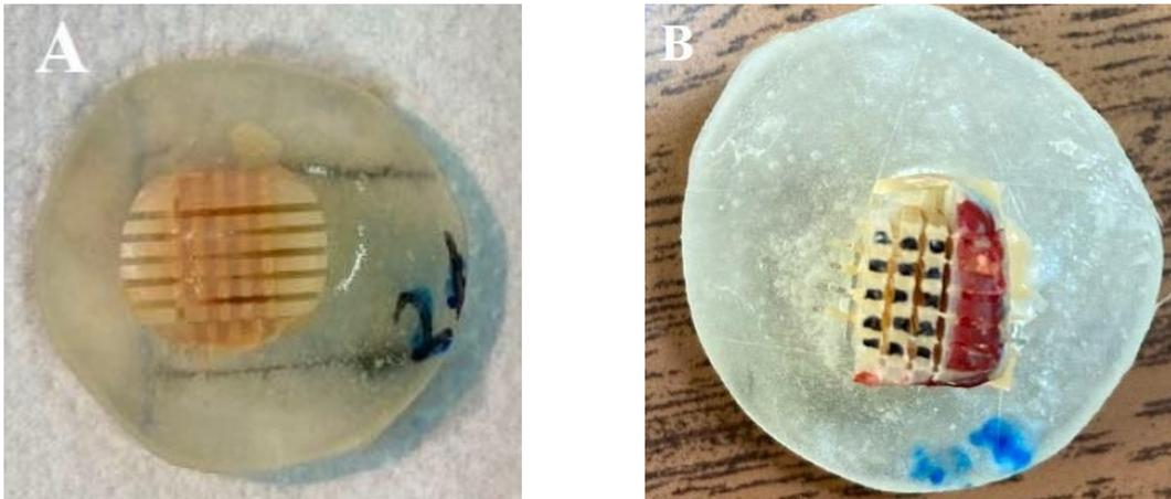
**Figura 2.7.** A: Molar restaurado com ambos os cortes longitudinais efetuados, B: Seleção dos bastonetes para ensaio  $\mu$ TBS
