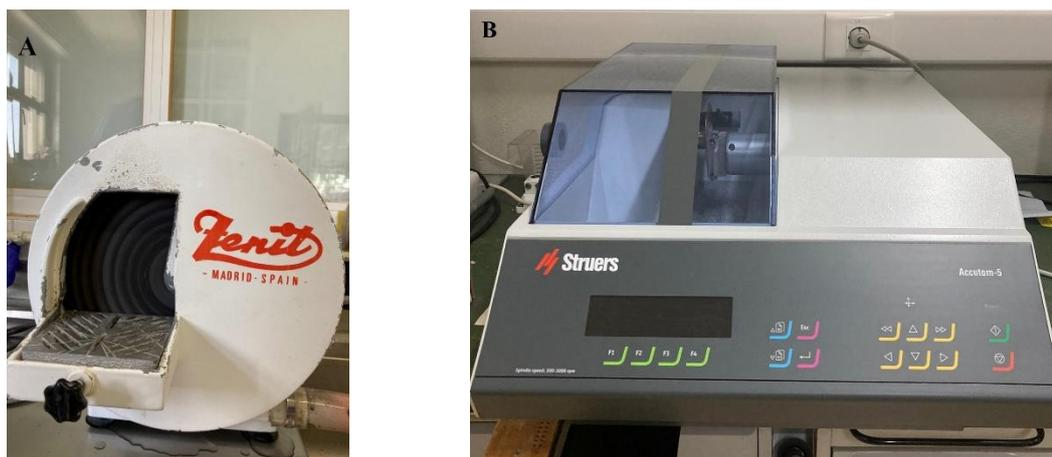
**Figura 2.2.** A-Máquina cortadora de gesso (Zenit); B-Serra elétrica (Stuers Accutom-5).
