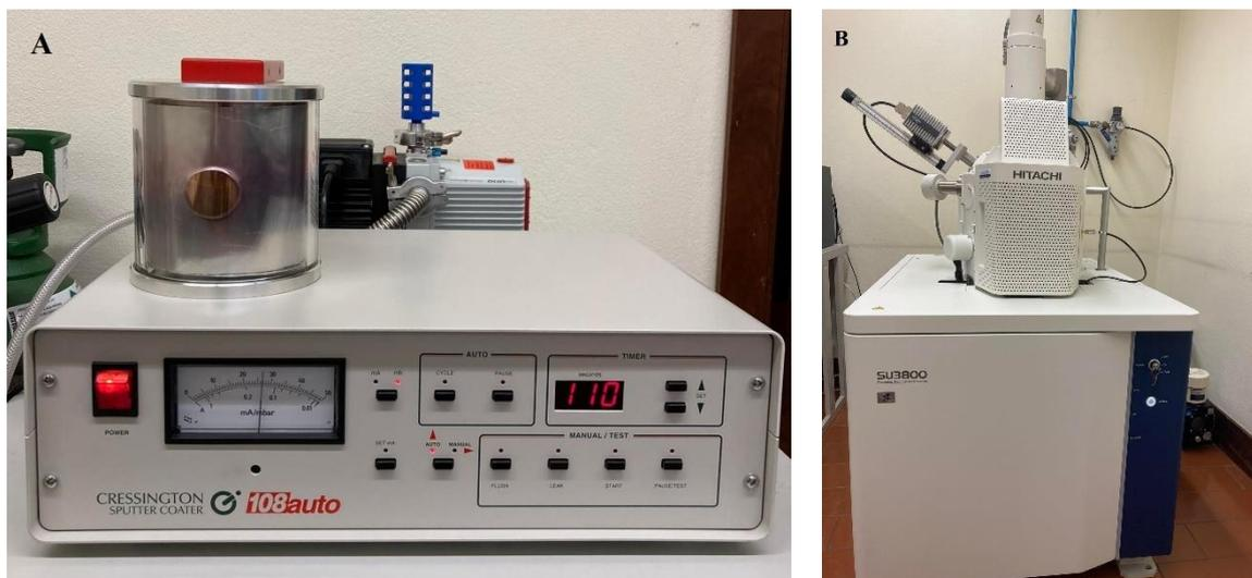
Figura 2.12. Equipamento de revestimento Cressington 108 Sputter Coater B: Microscópio HITACHI SU3800
