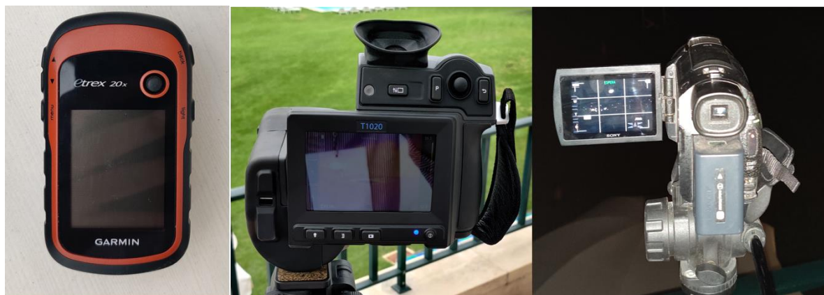
Figura 3.1. Equipamentos utilizados nos espetáculos de fogo de artifício (GPS, câmara termográfica e câmara de vídeo, respetivamente).
