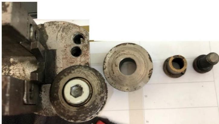
**Figura 2.6.** Rolete, casquilho e parafuso (montado e desmontado).
