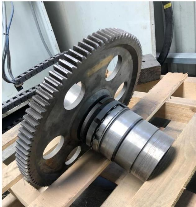
**Figura 2.1.** Roda dentada acoplada ao veio de transmissão de potência responsável pela rotação do braço de conformação (contém as ferramentas de conformação).
