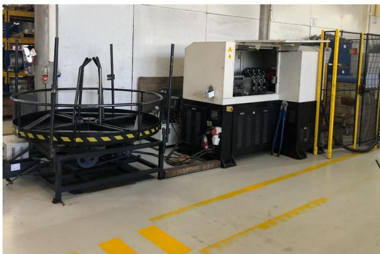
**Figura 1.5.** Vista global da uma máquina de conformação de arame (CMM6-800R) utilizada na empresa.
