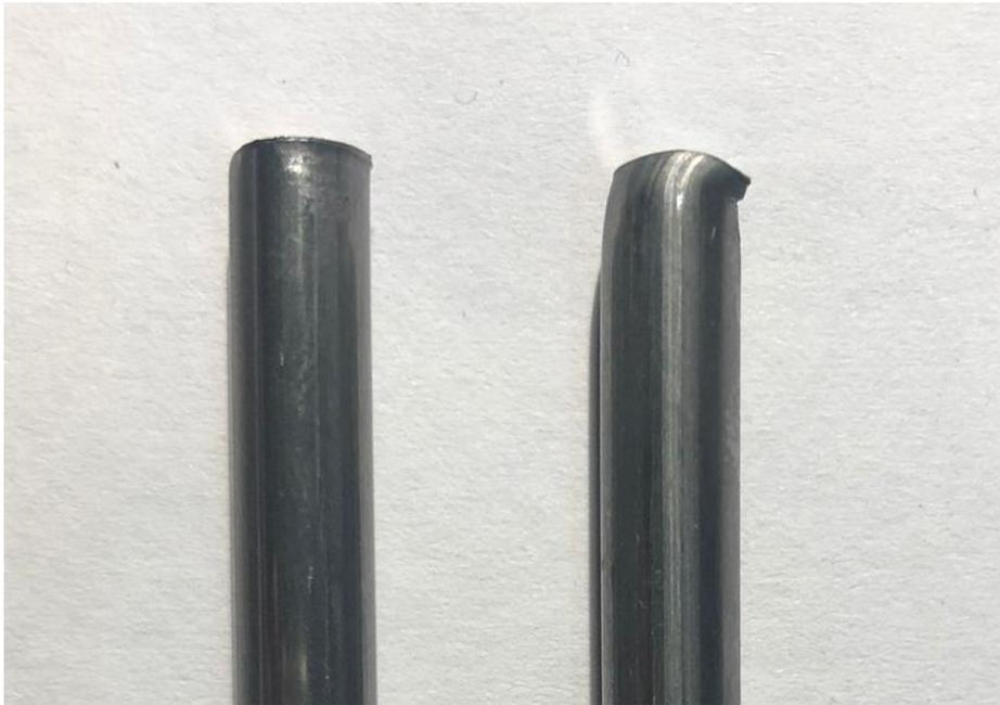
**Figura 2.5.** Contraste entre cortes de arame: corte limpo, fruto de boa afinação dos componentes de corte (esquerda); corte deficitário com deformação plástica e rebarba, fruto de folga excessiva entre os intervenientes no corte (direita)
