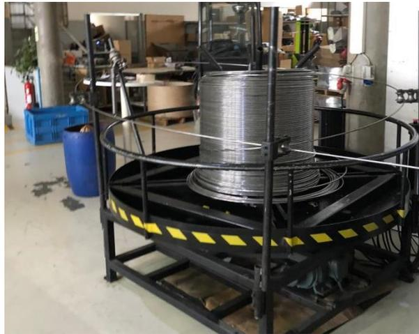
**Figura 1.6.** Bobine de arame inserida na parábola durante o processo de desenrolamento.
