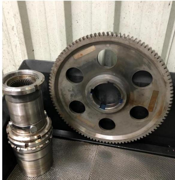
**Figura 2.9.** Veio de transmissão de potência e roda dentada após modificação, com quatro escatéis e quatro chavetas.
