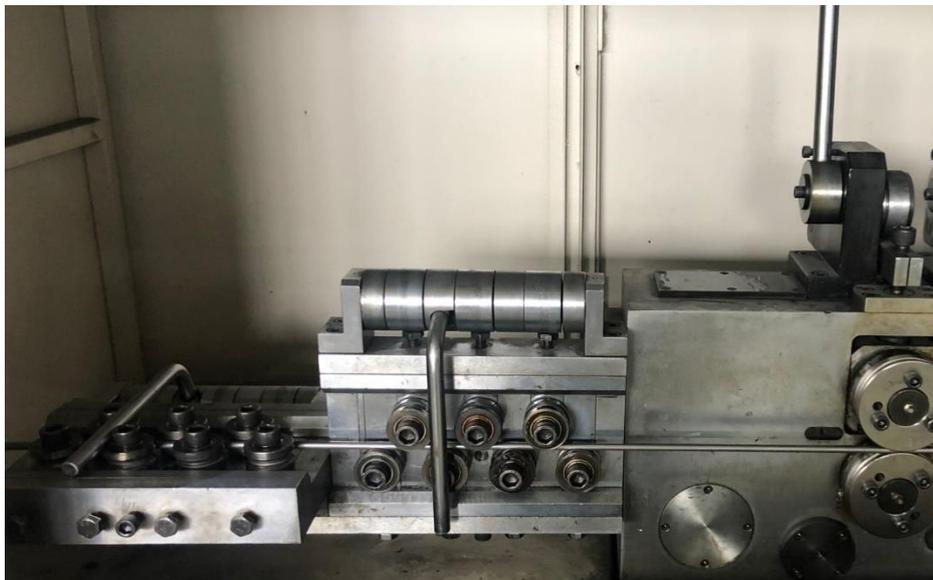
**Figura 1.7.** Sistema de roletes utilizado na linearização do arame antes da operação de conformação.
