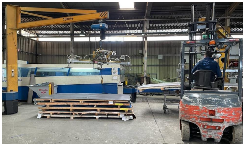
Figura 4 – Transporte da Chapa para a máquina através de braço mecânico
