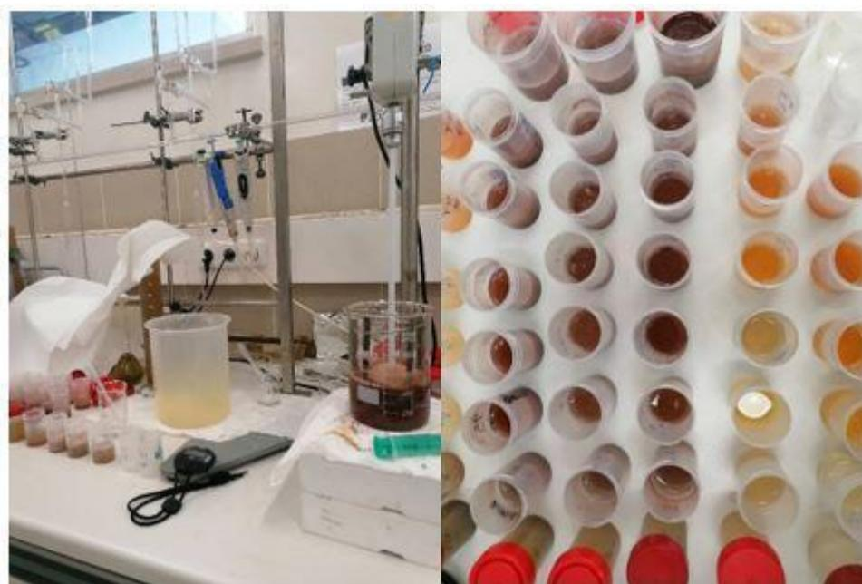
Figura 5.1.: a) Experiência laboratorial Fenton; b) Diferentes colorações das amostras
