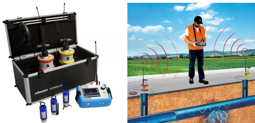
**Figura 6** - Correlacionador de ruído, à esquerda e o seu respetivo funcionamento na imagem à direita imagens retiradas de <http://www.sondeq.com.br>
