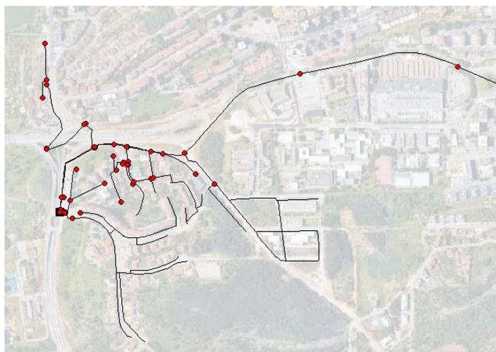
**Figura 32** - Nós com pressões superiores ao máximo regulamentar
