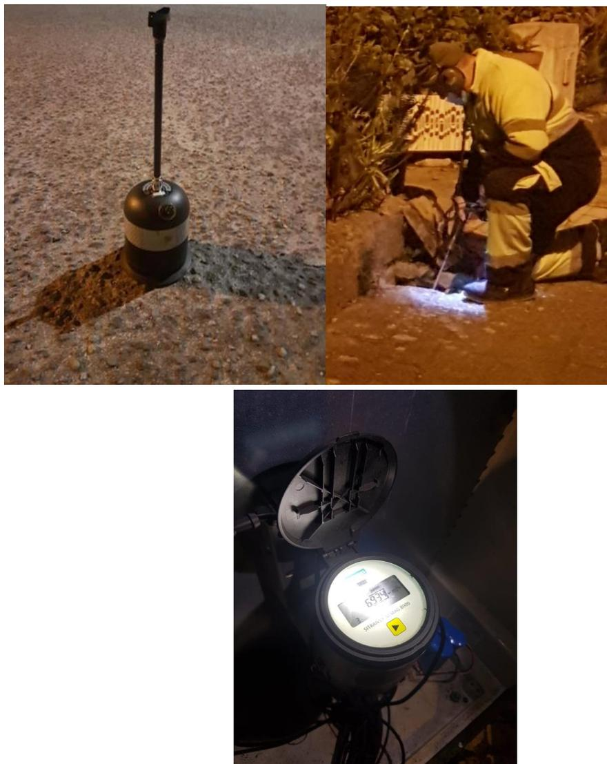
**Figura 18** - Geofone (em cima à esquerda), Detecção da fuga em cima à direita, Caudalímetro em baixo
