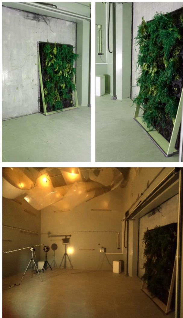
Figura 4.14 – Montagem do sistema modular de fachada verde dentro da câmara reverberante.
