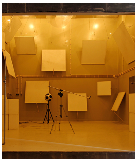
Figura 3.2 - Câmara reverberante instalada no Itecons (fonte: Itecons, 2022).
