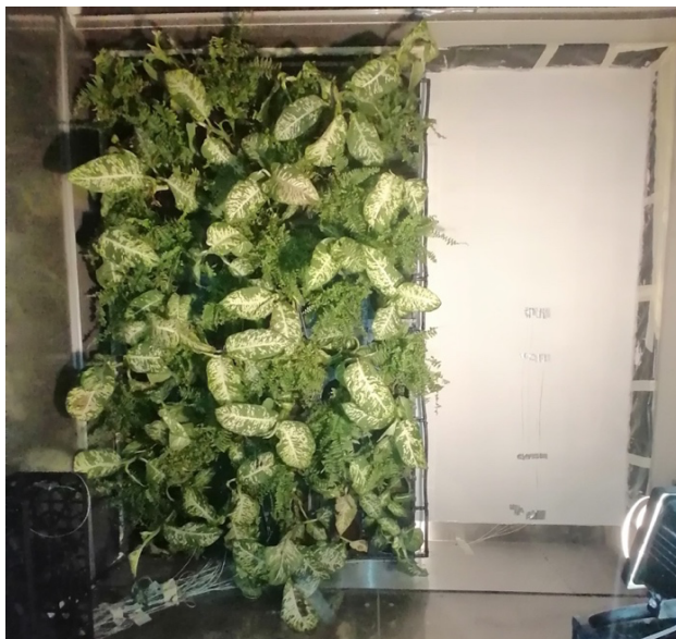
Figura 4.6 - Montagem completa do sistema modular de fachada verde.
