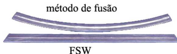
Figura 2.3 Comparação da deformação entre soldadura por fusão e no estado sólido, adaptado de Hatachi, [62].
