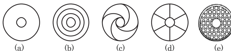
Figura 2.10 Diferentes tipos de base muito utilizados: (a) base lisa; (b) base plana com estrias concêntricas; (c) base plana com estrias em espiral; (d) base plana com estrias radiais; (e) base plana com estrias não concêntricas, adaptado de Podrzaj et al , [96].
