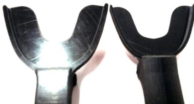
Figura 2.49 - Foto ilustrativa das diferentes dimensões da goteira superior no protótipo 3 (à esquerda) e no protótipo 2 (à direita).
