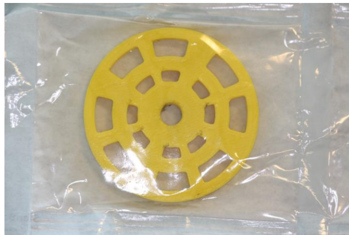
Figura 2.57 – Peça de ABS posteriormente a 3 ciclos de esterilização, não demonstrando qualquer deformação macroscópica.
