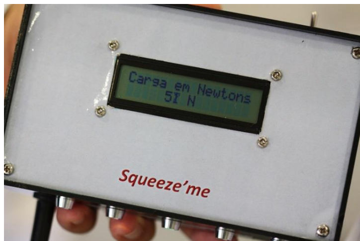
Figura 2.39 – Dispositivo Squeeze’m e para ligação de sensores FSR.
