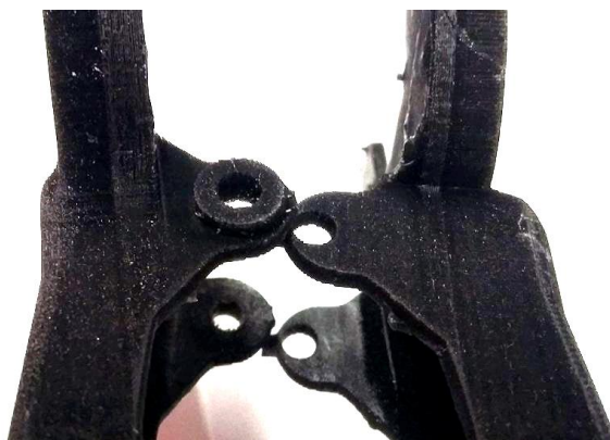
Figura 2.48 - Foto ilustrativa das diferentes dimensões e forma do mecanismo de retenção do pino interbraços superior e inferior no protótipo 3 (à esquerda, com um anel de reforço) e do protótipo 2 (à direita, de superfície mais plana e menos resistente).
