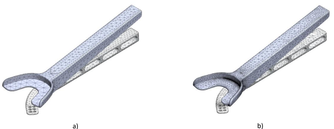
Figura 2.79 – Visualização da malha de elementos finitos: a) Modelo inicial; b) Modelo após convergência.
