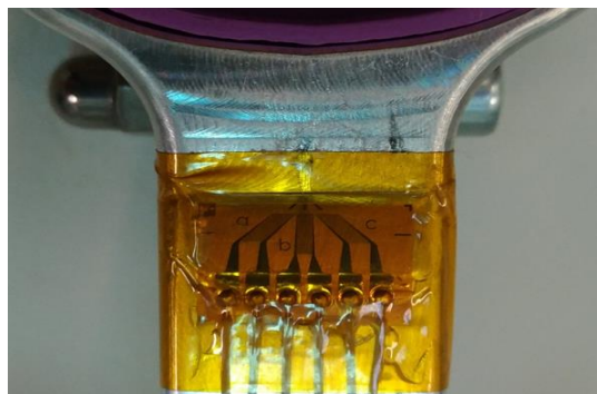
Figura 2.86 – Posicionamento e identificação dos extensómetros da roseta extensométrica.
