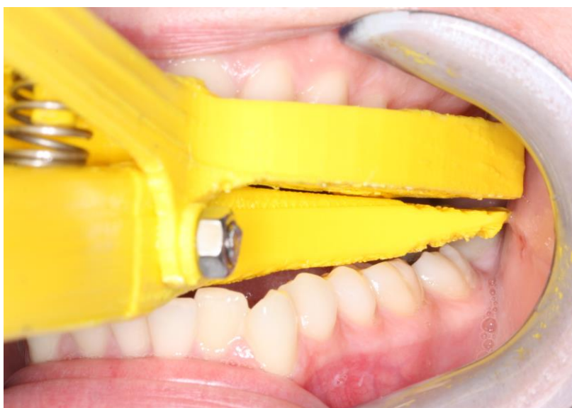
Figura 2.52- Adaptação intra-oral do modelo produzido em ABS do protótipo 4 às arcadas dentárias e ao molar alvo.
