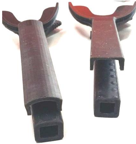
Figura 2.50 - Foto ilustrativa das diferentes formas da face superior do cabo do braço superior e inferior do dispositivo: face com curvatura no protótipo 2 (à esquerda) e face plana do protótipo 3 (à direita).
