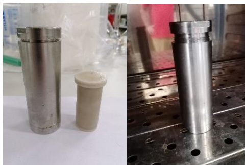
Figura 3.3 – Exemplo de um mini-reator utilizado na etapa de dissolução da madeira
