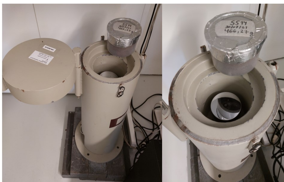
Figura 18 – Espectrômetro NaI do LRN-UC.
