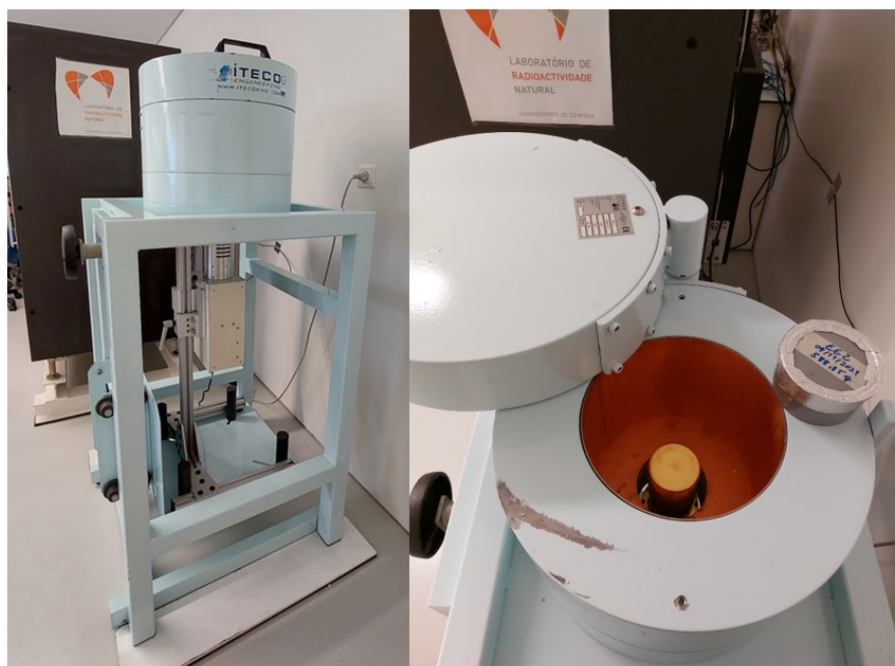
Figura 17 – Espectrômetro HPGe do LRN-UC.
