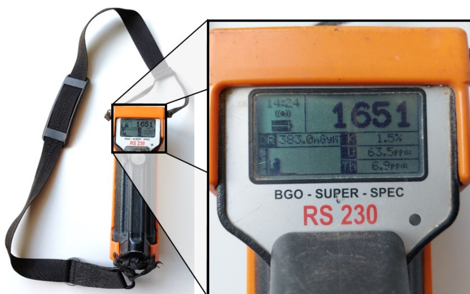
Figura 16 – Espectrómetro portátil RS-230, com indicação dos parâmetros medidos no visor (RGT, DR, K, U e Th).
