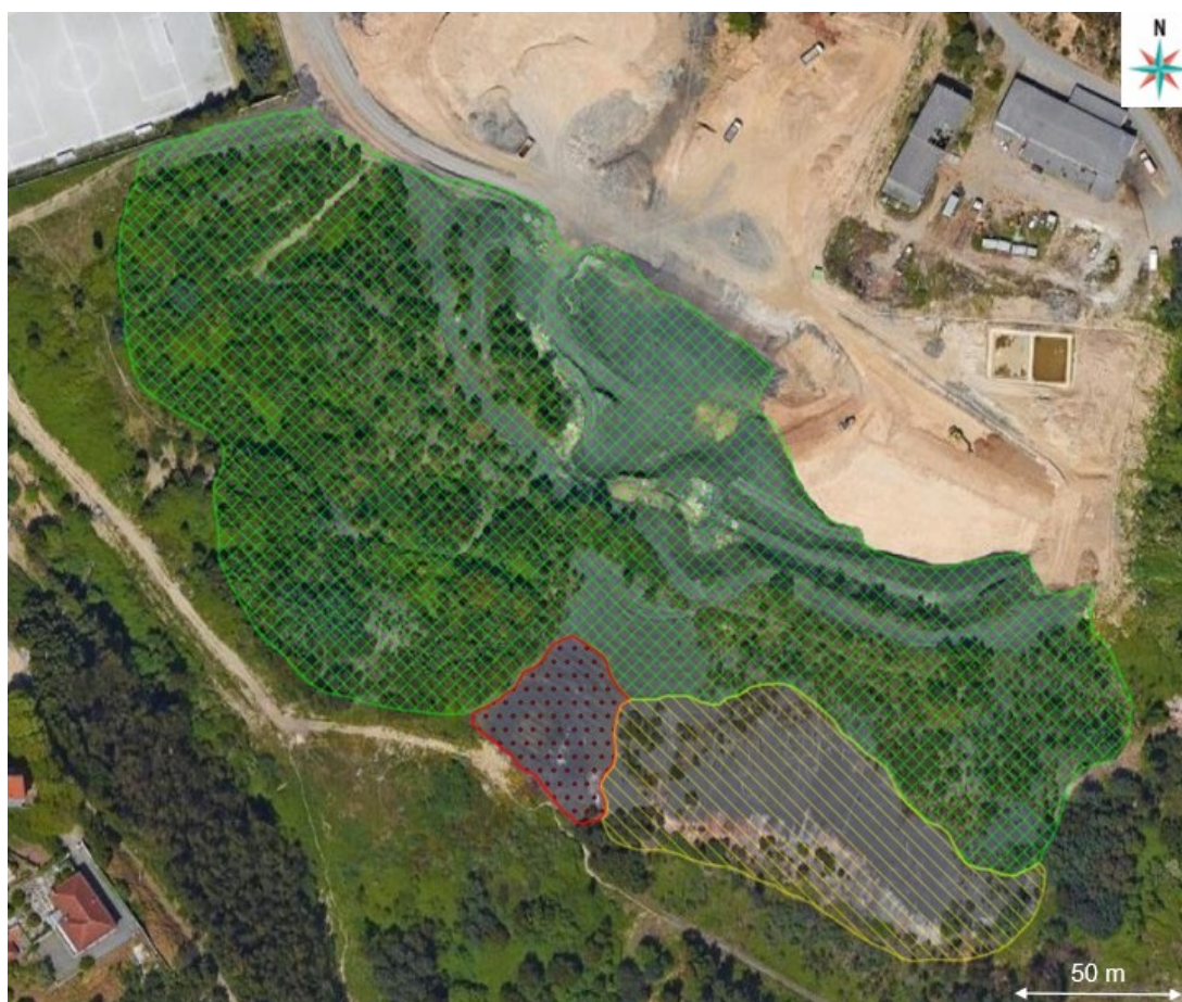
Figura 4 – Imagem área da escombreira de SPC, com identificação aproximada da área queimada a amarelo, da área atualmente em autocombustão a vermelho e da área não queimada a verde (Google Earth, acedido em maio de 2022).
