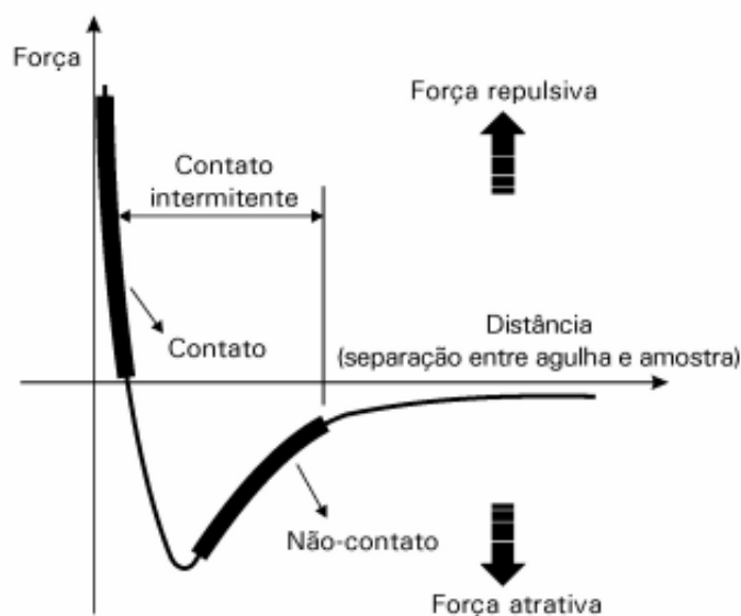
Figura 10. Representação esquemática das forças entre a amostra e agulha em função da distância, caracterizando os diferentes modos de trabalho do microscópio de força atômica. Retirada de 59 .
