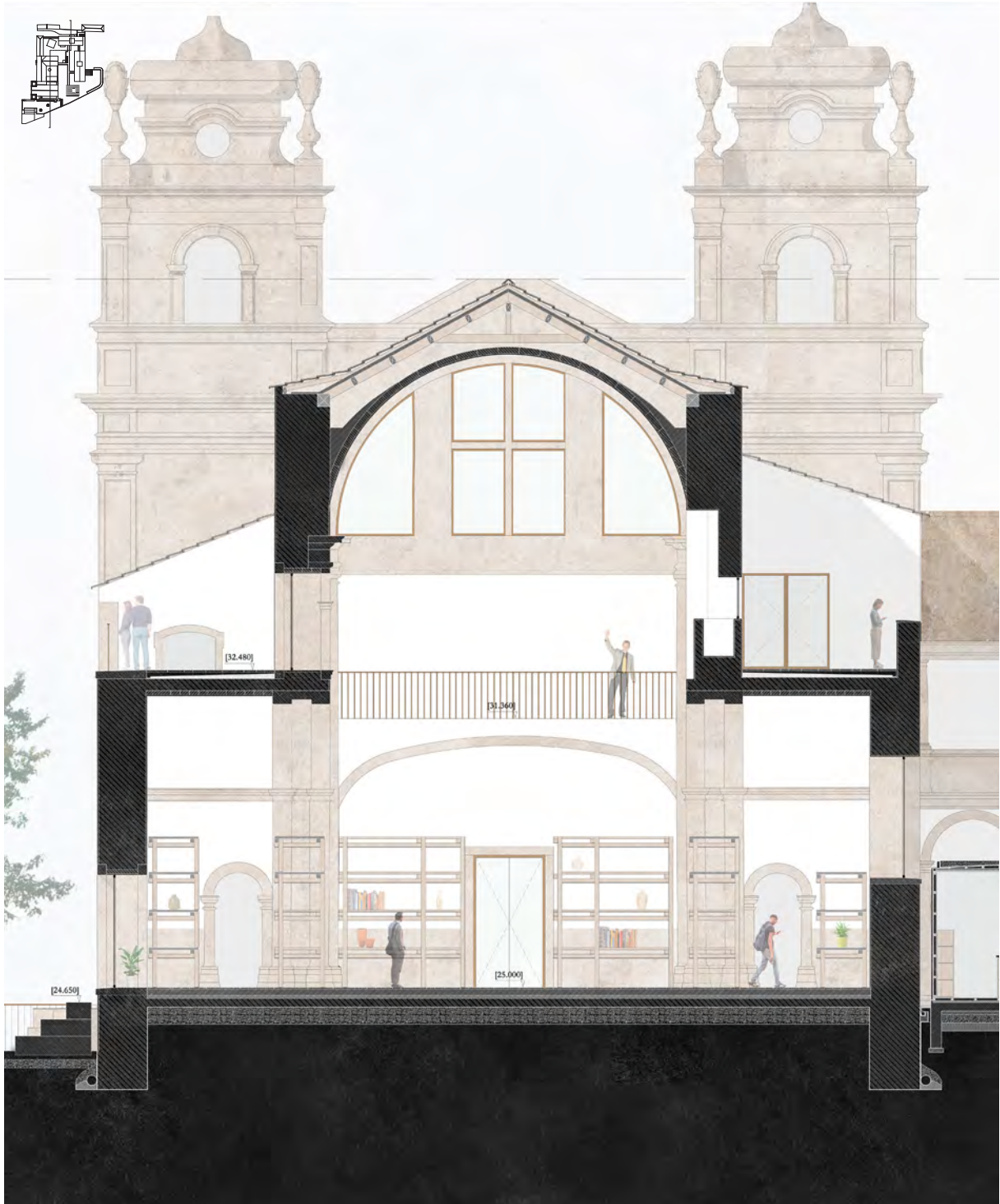
Fig. 97 | Corte construtivo da igreja
