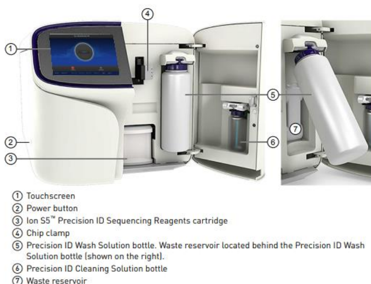
Fig. 9. Representação do Ion S5™ System pronto para realizar a sequenciação do chip, adaptada do manual “Precision ID GlobalFiler™ NGS STR Panel v2 with the HID Ion S5™ / HID Ion GeneStudio™ S5 System”.
