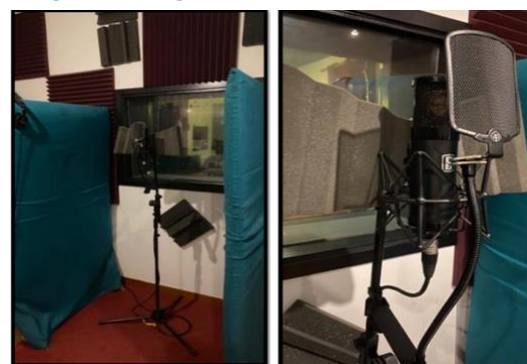
Figura 47 - Instalação do Microfone Slate Digital MI-1 na sala de captação do Loudstudio
