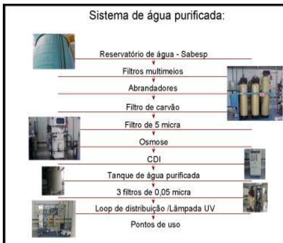
Figura 4.1. Fluxograma do sistema de tratamento de água estudado, com os treze pontos de amostragem representados.
