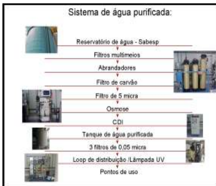
Figura 5.1. Fluxograma do sistema de tratamento de água estudado, com os treze pontos de amostragem representados.
