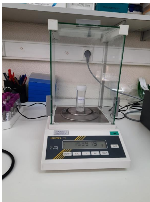
Figura 1. Pesagens dos frascos utilizando uma balança analítica KERN 770.
