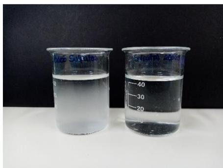
**Figura 35** – Comparação da opalescência da solução padrão (à esquerda) com a solução que contém cloridrato de glucosamina (à direita).
