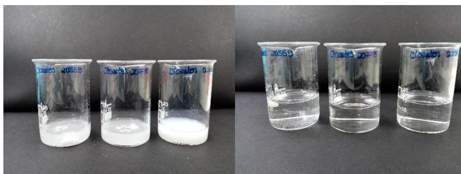
Figura 34 – À esquerda, é possível observar a formação de precipitado branco pela adição de nitrato de prata. À direita, é apresentada a solução límpida que resulta da dissolução do precipitado. Os gobelés contém a matéria-prima pela ordem em que aparecem na tabela 14.
