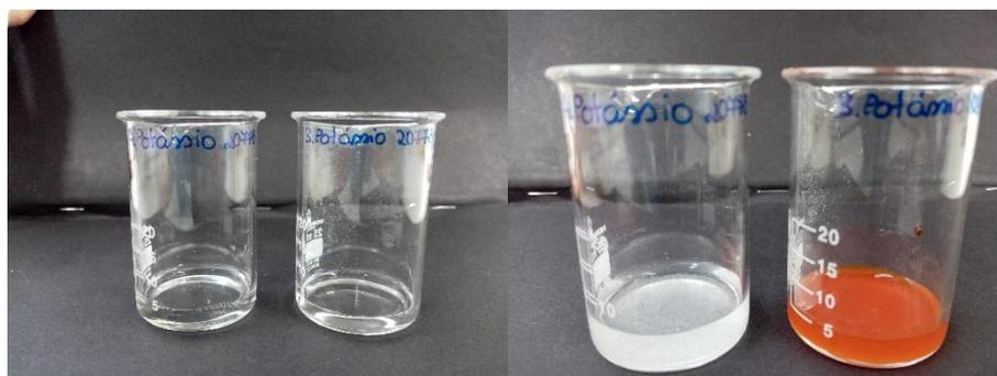
Figura 36 – Ensaio da identificação do potássio: à esquerda é possível observar as preparações das reações A e B antes de haver formação de precipitado. À direita é possível observar a formação de precipitado tanto para a reação A, como para a B.
