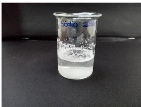
Figura 37 – Formação de precipitado sódico para o sulfato de glucosamina NaCl.
