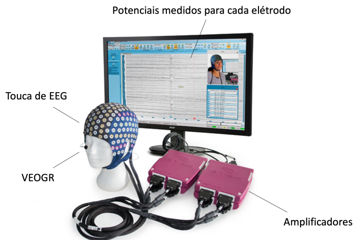
Figura 4.1: Sistema de aquisição habitualmente usado na eletroencefalografia, adaptado de [79]
