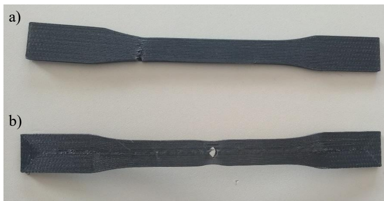
Figura 4.2. Modo de rotura em carregamento estático: a) provete quasi-isotropic ; b) provete concêntrico
