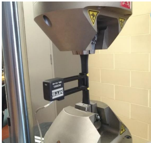
Figura 3.2. Setup dos ensaios de fadiga de curta duração, com máquina Instron ElectroPuls TM E10000 e extensómetro MTS 632.12C-20.
