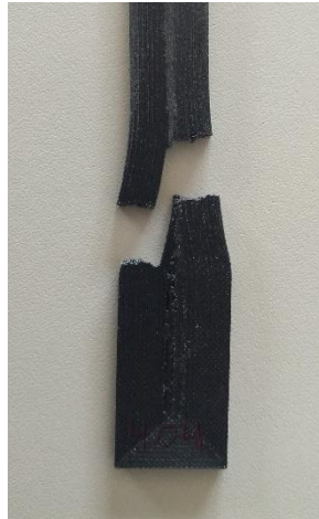
Figura 4.20. Exemplo de delaminação entre filamentos.
