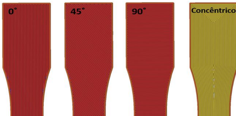
Figura 3.1. Esquema dos tipos de geometria interna, sendo 0° 45° e 90° correspondentes às várias direções dos filamentos no lay-up Quasi-Isotropic e, à direita, o lay-up concêntrico.
