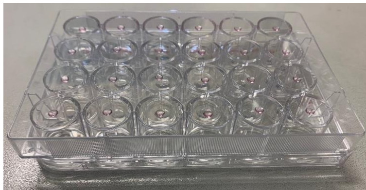
Figura 18: Placa de 24 poços não aderente com uma gota de suspensão celular em cada poço, colocada sobre a tampa com as gotas de PBS.
