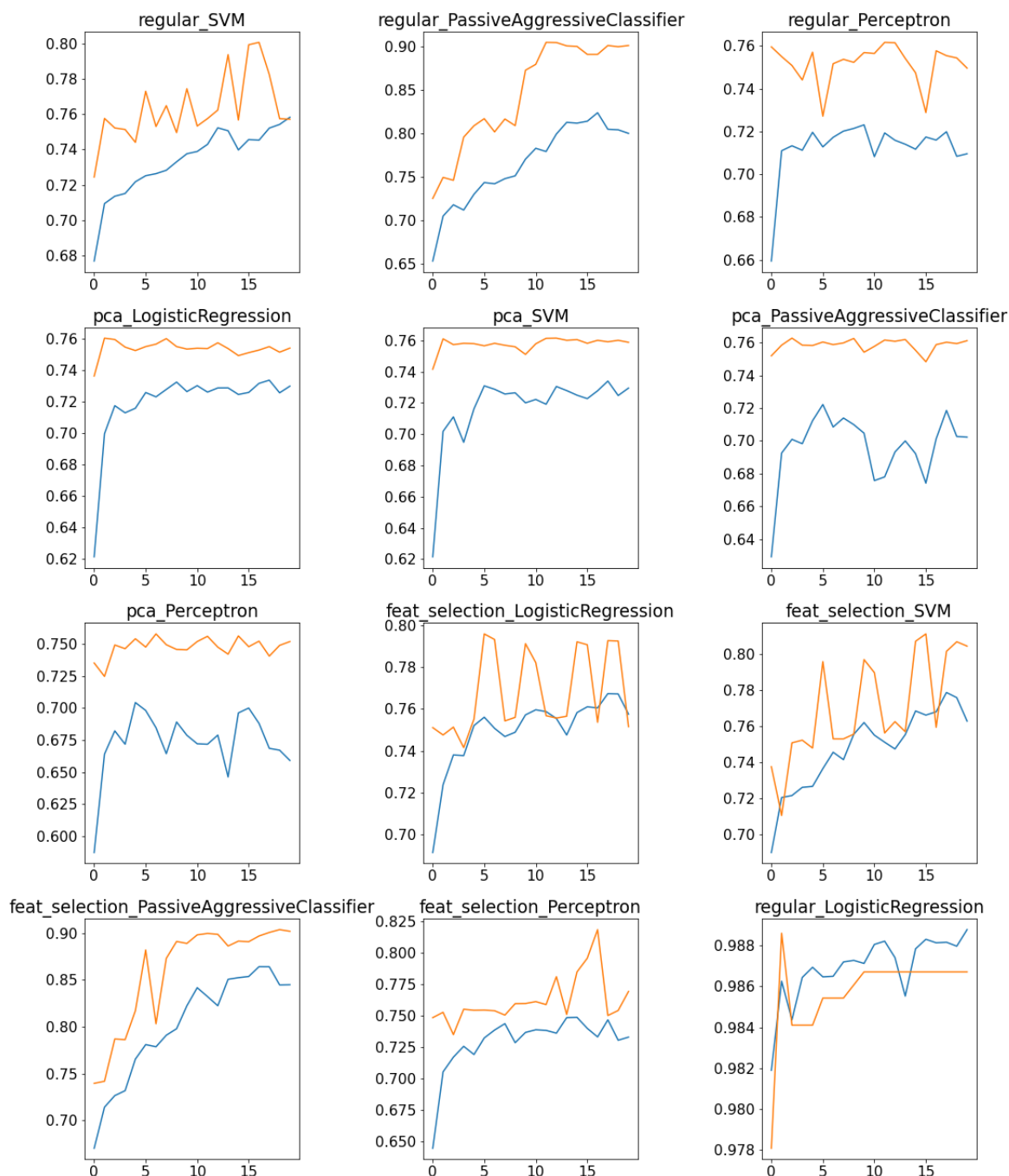
Figura 5.3: Resultado dos testes para CIC-17 com adiç3o de dados em todos rounds . No eixo X temos cada Round (0 a 19) e no eixo Y pode-se identificar os valores da evoluç3o da m3trica f1 -score. A linha em azul representa a evoluç3o dos clientes m3dia, o que nos permite verificar que a combinaç3o de { feat_selection , PassiveAggressiveClassifier } chega a 84,5% para o f1 -score m3dio, por parte dos clientes. Em laranja temos a evoluç3o por parte do Server podemos identificar que a mesma combinaç3o obteve melhores resultados, chegando a obter f1 -score de 90,2%.
