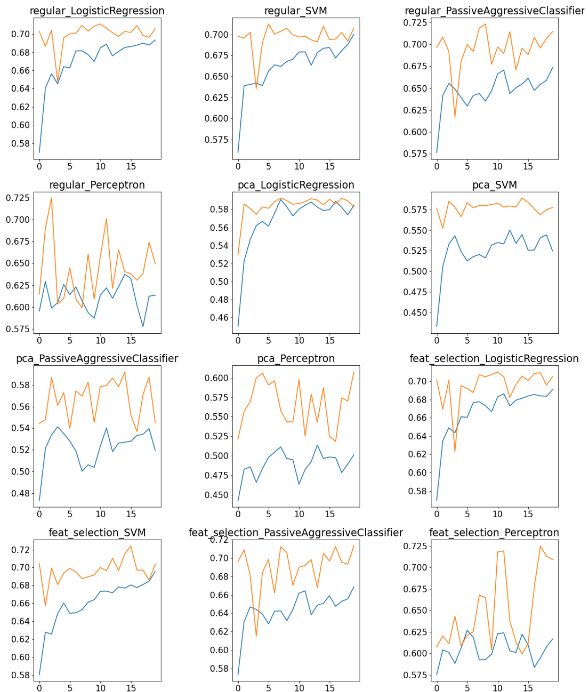
Figura 5.6: Resultado dos testes para TON com adição de dados em todos rounds , contexto multi-classe. No eixo X temos cada Round (0 a 19) e no eixo Y pode-se identificar os valores da evolução da métrica f1 -score. A linha em azul representa a evolução dos clientes média, o que nos permite verificar que a combinação de {regular, SVM} alcança a 70% para o f1 -score médio, por parte dos clientes. Em laranja temos a evolução por parte do Server podemos identificar que a mesma combinação obteve melhores resultados, chegando a obter f1 -score de 71%.
