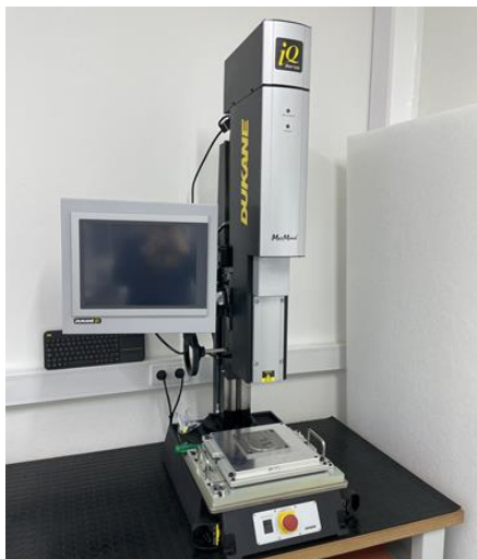
Figura 3.2. Prensa de Soldadura Ultrassónica Dukane IQServo 43S220 , presente no laboratório da Wondermac , utilizada nas soldaduras.
