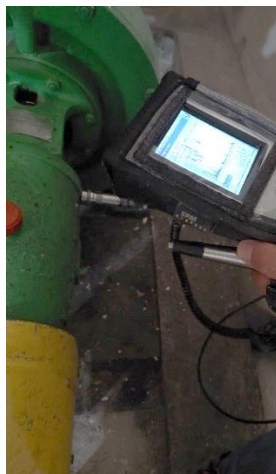
Figura 5.17. Medição horizontal com acelerómetro piezoelétrico
