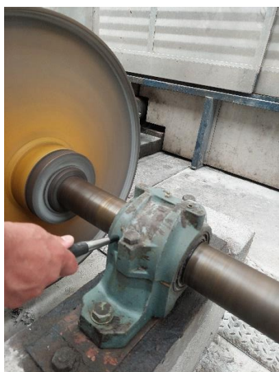
Figura 5.21. Medição vertical pulso de choque chumaceira nº12
