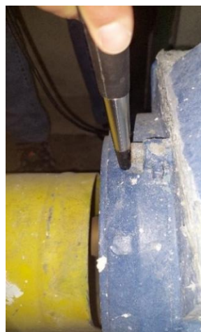
Figura 5.16. Medição com transdutor piezoelétrico num motor
