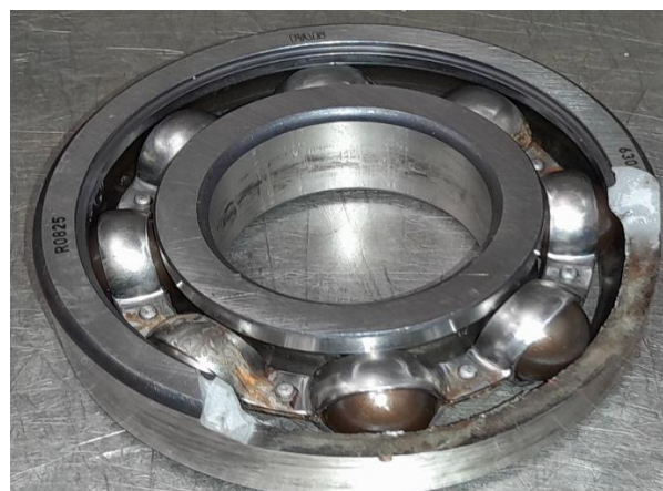
Figura 5.24. Rotura no rolamento do lado oposto ao acoplamento do tinão de mistura
