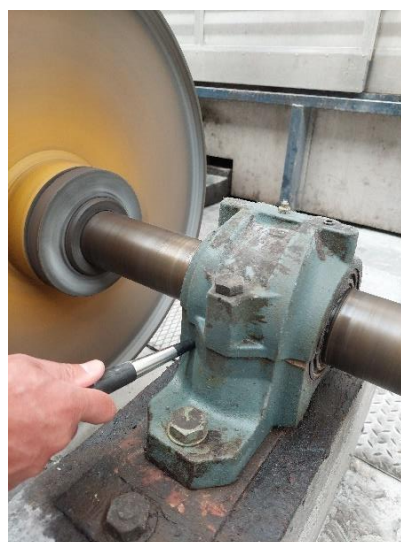
Figura 5.22. Medição horizontal pulso de choque chumaceira nº12
