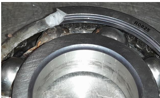
Figura 5.23. Danos na pista externa do rolamento do lado oposto ao acoplamento
