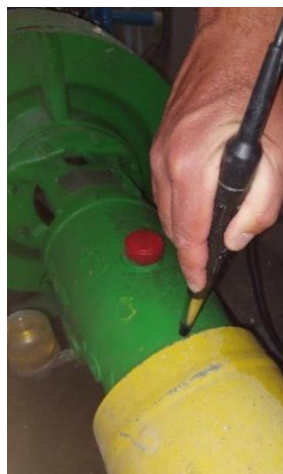
Figura 5.15. Medição com transdutor de piezoelétrico numa bomba
