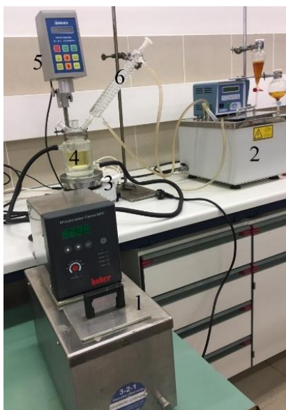
Figura 16: Montagem experimental para o estudo da monitorização da transesterificação. 1- Banho termostático; 2- Banho de arrefecimento, 3- Placa de agitação magnética; 4- Reator em vidro; 5- Viscosímetro Brookfield; 6- Condensador; 7-Termómetro digital.
