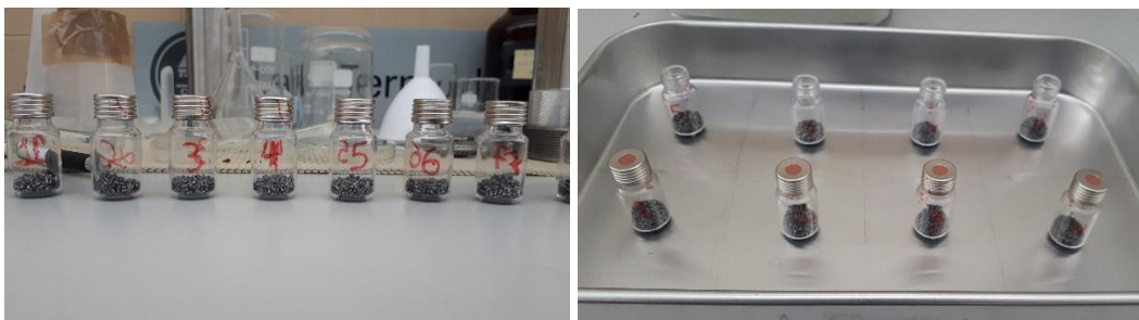
Figura 3.2. Registo fotográfico das amostras a ser colocadas na estufa.
