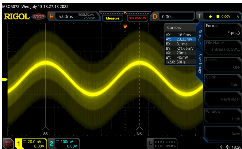
Figura E.5: Sinal de entrada proveniente do gerador de sinal (equivalente a um sinal de uma corrente primária de 1kA).
