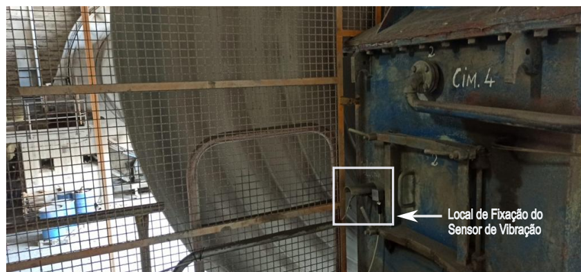
Figura 5.13: Posicionamento do sensor de vibração no moinho de cimento.
