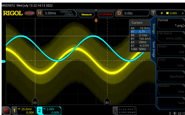
Figura E.9: Sinal de entrada do sensor de Rogowski (amarelo) e sinal de saída do 4º estágio (azul).
