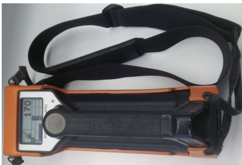
Figura III 5. Espectrómetro portátil RS-230 super-Spec (in Sêco, 2019).
