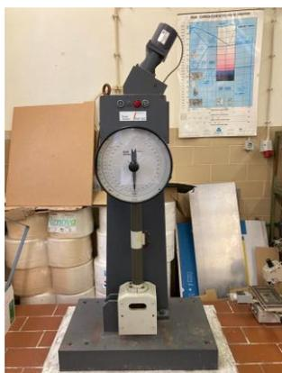
**Figura 3.4.** Equipamento para Ensaio Charpy.
