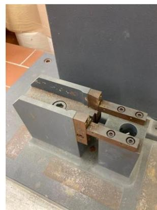
**Figura 3.6.** Suporte de colocação dos provetes.
