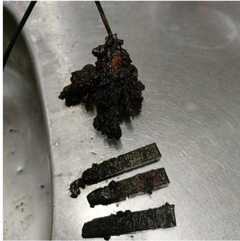
**Figura 4.10.** Provetes degradados em HCl com tensão, ao fim de 10 dias de degradação.
