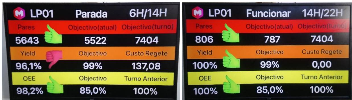
Figura 9 - Sistema "Andon" da LP1
