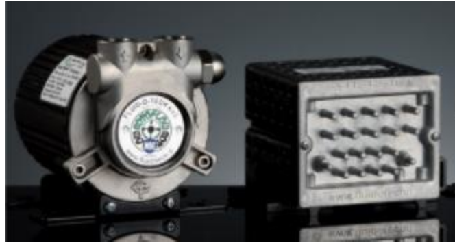
Figura 2.6. Fotografia da bomba e respetivo variador de velocidade disponível no DEM.
