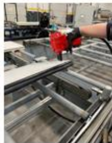
3. Rebitar o Perfil - 2 Rebites nas Pontas - 1 Rebite na Borracha nas Pontas - 1 Rebite no meio pelo Interior
