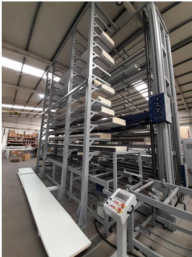
Figura 9 - Buffer da linha de montagem
