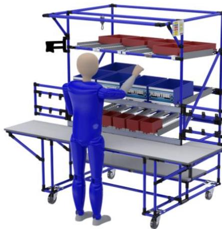
**Figura 4.3.** Exemplo de um posto de trabalho para a linha de reembalamento (*FlowTube*)
