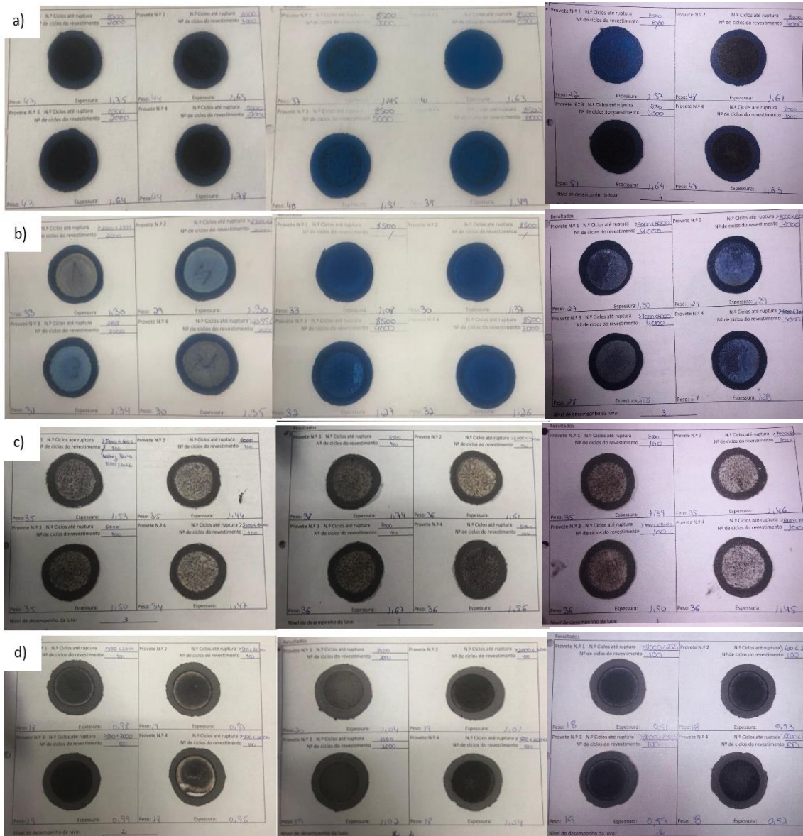
Figura VI.2 - Resultado do teste de abrasão: a) F0153X, artigo N3500; b) F0153, artigo N1500; c) NITPUG, artigo P5000; d) NITPUG, artigo P1100.
