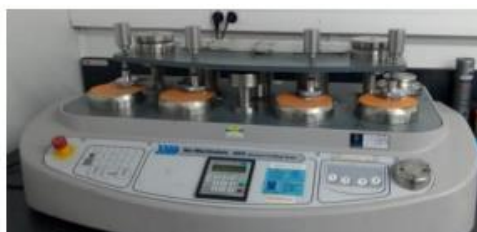
Figura 3.13 - Equipamento Martindale para teste de abrasão.
