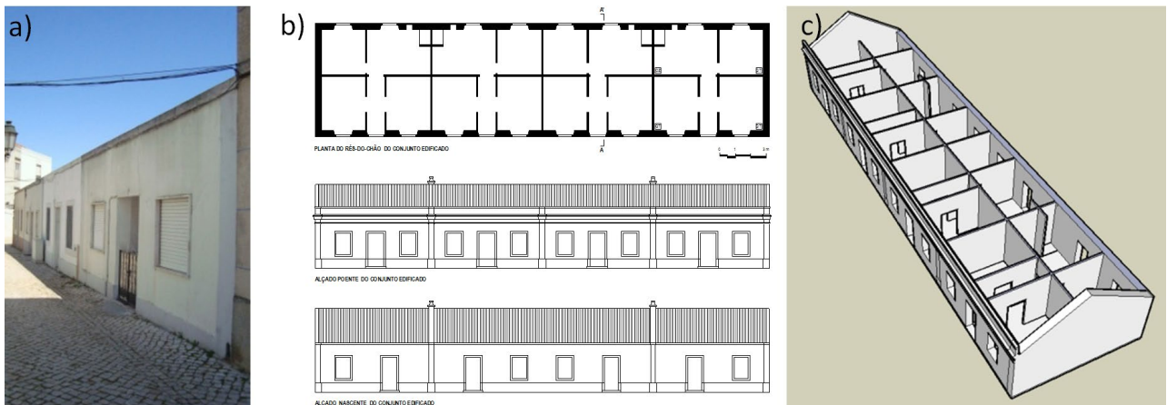
Figura 5. Edifício em banda térreo: a) vista exterior; b) projecto original; c) modelo tridimensional.
