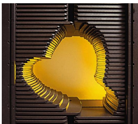
Figura 3 - Folhas de placas colimadoras de metal pesadas de um Multileaf-collimator posicionadas para moldar a radiação de vários feixes
