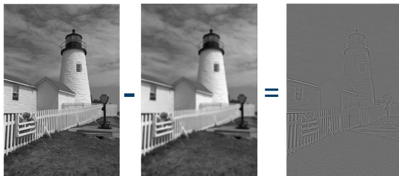
Figura 2.9: Ao subtrair a imagem esbatida, com o filtro gaussiano, à imagem original, obtêm-se os detalhes dessa imagem, ou seja, o laplaciano Fonte: (Dyrdal, Dyrdal)
