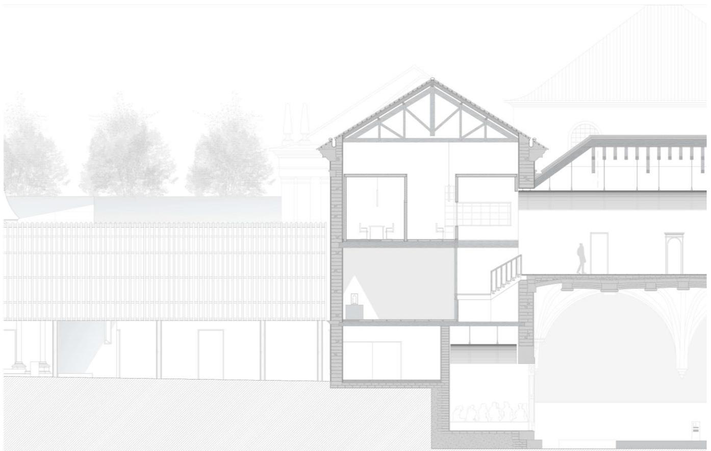
Fig. 94 – Corte longitudinal pelo edifício da DRCC, com o acesso vertical
