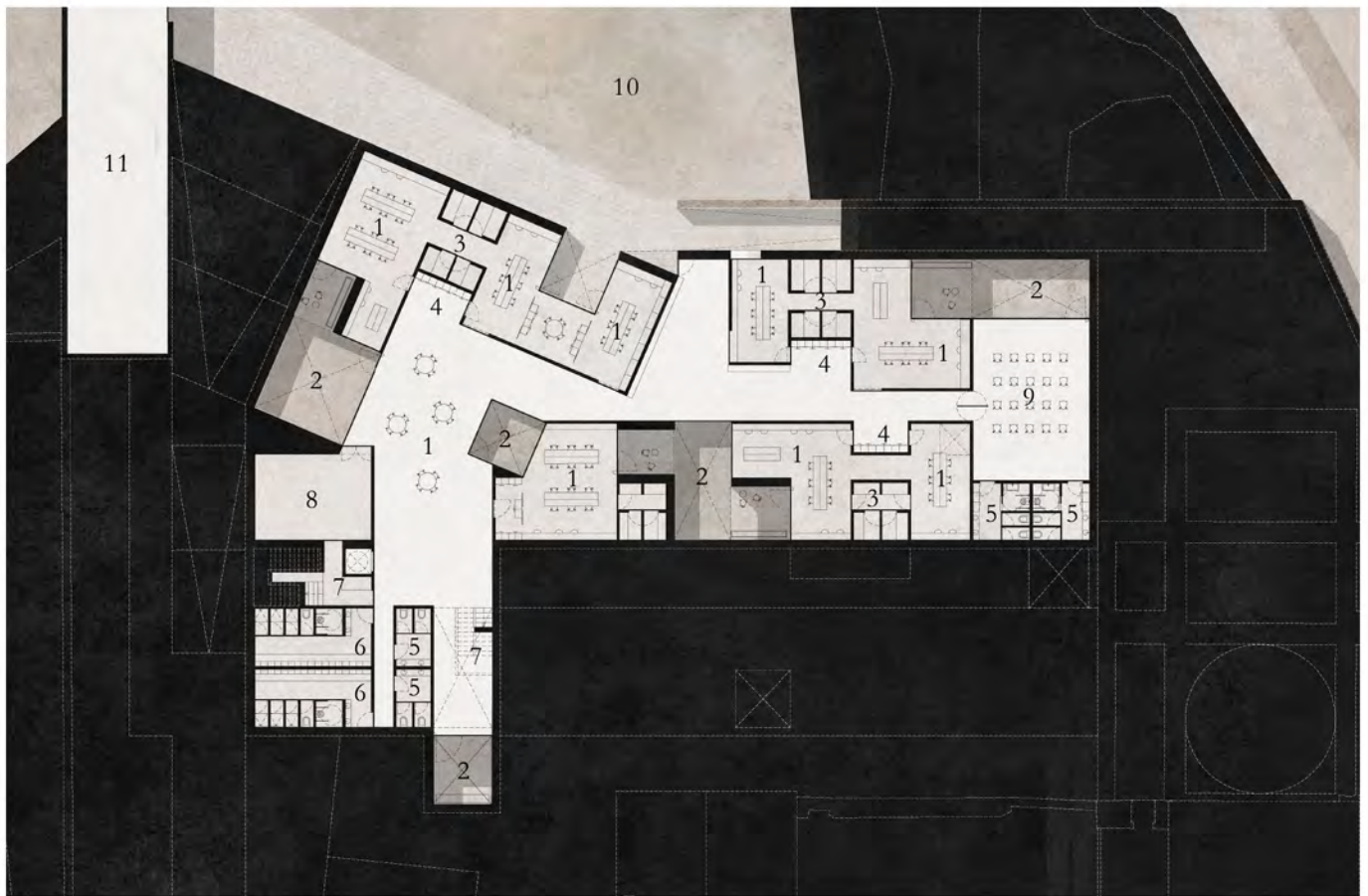
Legenda: 1. Laboratório 2. Pátio 3. Salas de Apoio aos Laboratórios 4. Antecâmara 5. I.S 6. Banheiros 7. Acessos Verticais 8. Zona Técnica 9. Sala de Conferências 10. Campo Experimental 11. Abrigo Material de Campo
