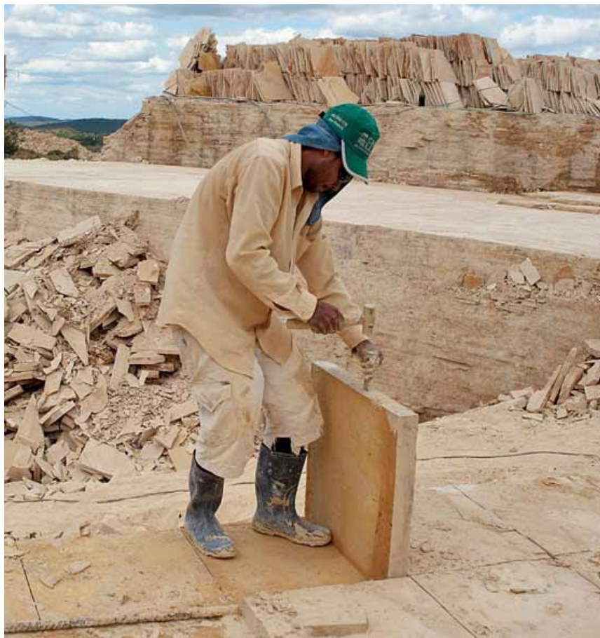
Figura 3.3 – Trabalho de exploração do calcário laminado, comercialmente denominado da Pedra Cariri, no município de Nova Olinda, para uso ornamental na construção civil. Município de Nova Olinda
