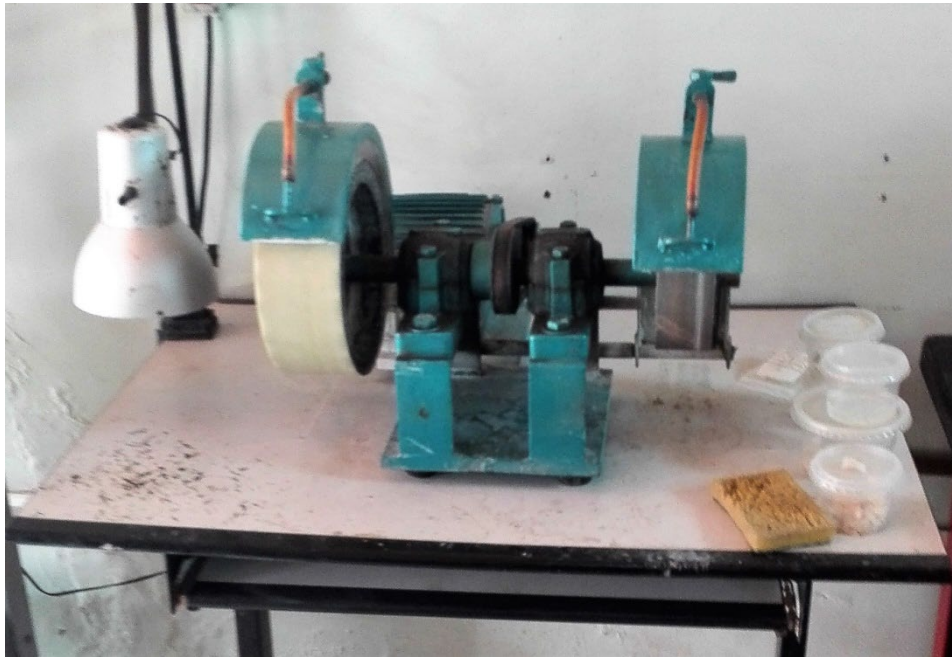
Figura 7:44 - Esmeril com rebolo. Equipamento usado para polimento das gemas e pedras preciosas. Oficina do lapidário e joalheria Opalas Pedro II.
