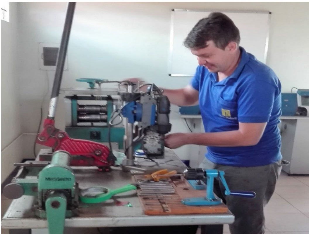
Figura 7.45 - Mesa com um perfurador de pedras, laminador de metais, e tesoura mecânica. Oficina do lapidário e joalheria Opalas de Pedro II.
