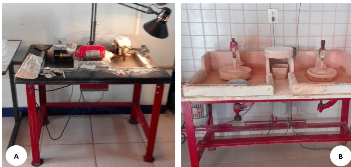
Figura 7.43 - Equipamentos do lapidário e joalheria Opalas Pedro II. A - Mesa formatação da pedra, que dá a forma desejada à gema, possuem diferentes granulações. B - Politriz, equipamento usado para polimento das gemas e pedras preciosas.
