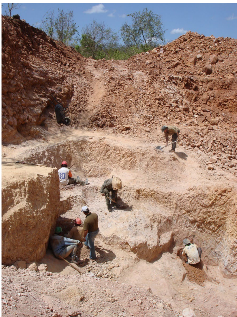
Figura 5.49 – Mina do Mamoeiro – cava onde está sendo feito o rebaixamento da bancada que contém o nível argiloso, com o objetivo de atingir a “laje” – diabásio.
