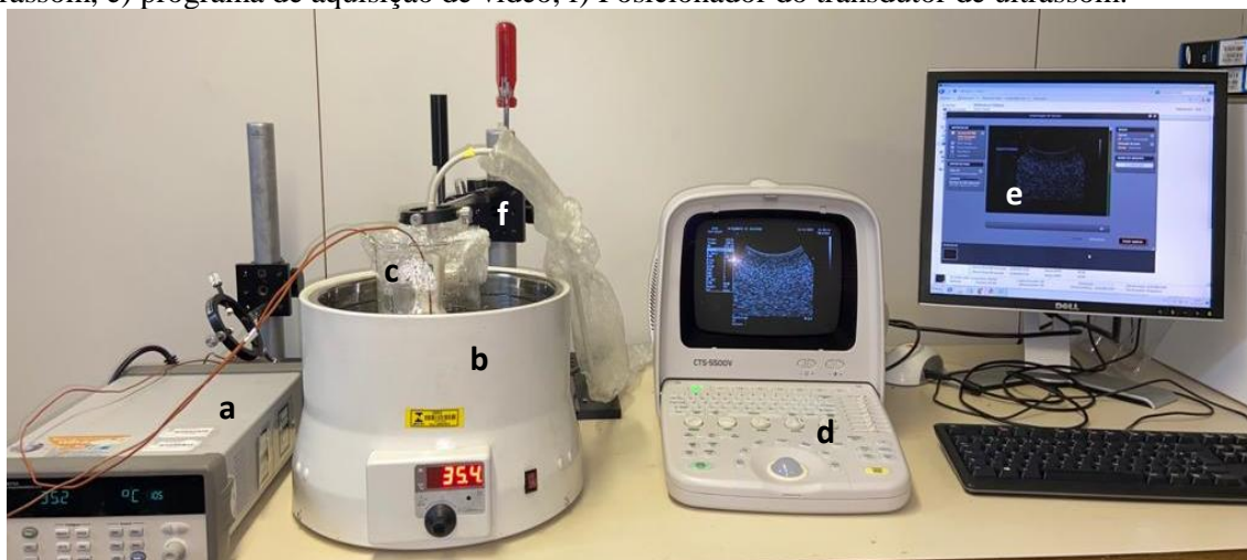
Figura 15 – Sistema experimental - Banho maria: a) unidade de aquisição de dados com dois termopares, b) banho térmico preenchido com água, c) béquer contendo o transdutor de ultrassom de imagem, o phantom de ágar e um absorvedor na solução (detalhe na Figura 16 ), d) equipamento diagnóstico por ultrassom, e) programa de aquisição de vídeo, f) Posicionador do transdutor de ultrassom.
