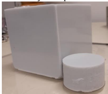
Figura 2 – Phantom cúbico maior (90 mm x 90 mm x 90 mm) e 1 amostra pequena ( Phantom G ) ( \varnothing 35 mm \times 28 mm) para a caracterização do phantom na solução
