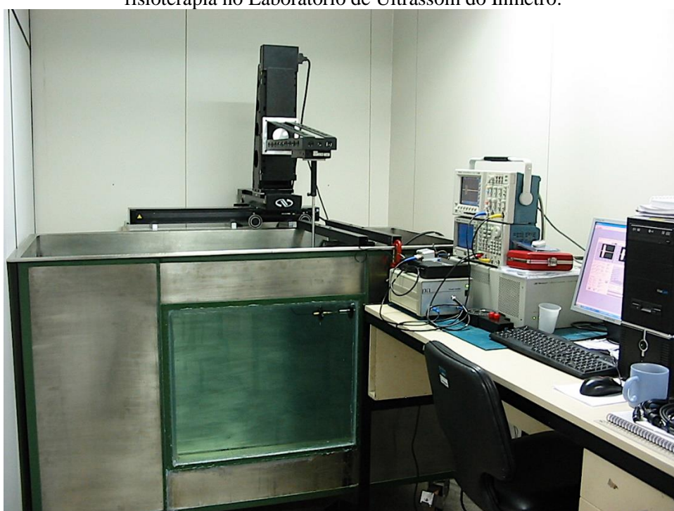
Figura 13 – Foto do sistema de mapeamento do campo acústico de equipamento de ultrassom de fisioterapia no Laboratório de Ultrassom do Inmetro.
