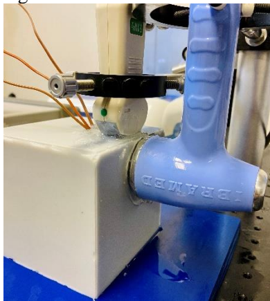
Figura 19 – Setup II: transdutor de imagem perpendicular ao feixe do UST no phantom cúbico com três termopares tipo J inseridos na região central do UST.
